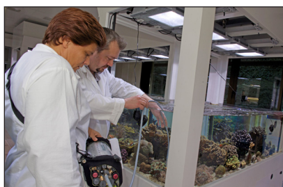
Analyse de l'état de santé des coraux avec le PAM (Pulse Amplitude Modulation)
