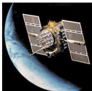
Un satellite de navigation comme ce satellite GPS envoie des signaux aux opérateurs qui les acheminent vers les avions, les navires, les véhicules ou les piétons qui les utilisent pour déterminer leurs positions.
