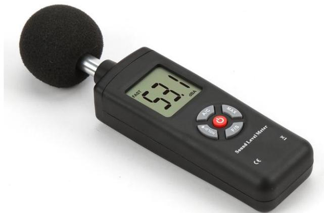
Ce sonomètre est muni d'un microphone. Il mesure le niveau de pression acoustique, une grandeur physique liée au volume sonore.
