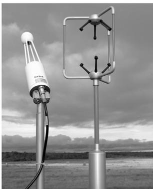
Capteurs de la tour LBA de la fazenda São Nicolau : le capteur de gauche évalue la concentration de gaz carbonique et celui de droite la vitesse et la direction du vent.
