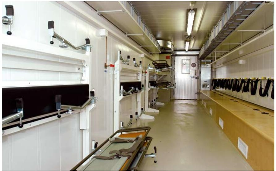
Véhicule de sauvetage du train d'extinction et de sauvetage
