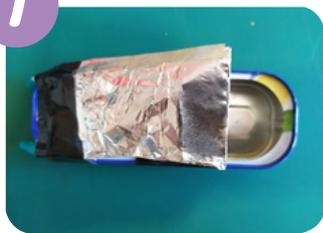
Replier la chaudière au-dessus de la bougie. Prendre soin de plier les pailles de telle sorte qu'il n'y ait pas d'angle, sinon l'eau vaporisée ne circulera pas. C'est pourquoi il est conseillé d'utiliser des pailles avec un embout long avant la partie pliable.
