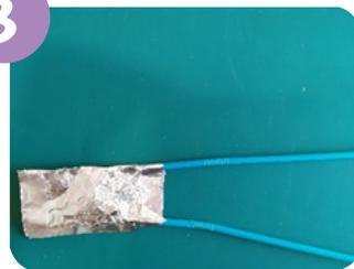
La poche est à peu près de la largeur de la bougie chauffe-plat. Protéger la longueur des pailles qui sera au contact de la bougie chauffe-plat en la recouvrant de ruban adhésif aluminisé.
