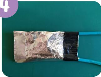
La poche doit envelopper l'extrémité des pailles de manière bien hermétique. Pour cela, enfiler d'un centimètre le bout des pailles (embout par lequel on aspire habituellement pour boire) dans la poche d'aluminium et fermer la poche parfaitement à l'aide de ruban adhésif aluminisé, puis recouvrir et bien serrer avec du ruban adhésif d'électricien ensuite. Cet ensemble s'appelle une **chaudière**.
