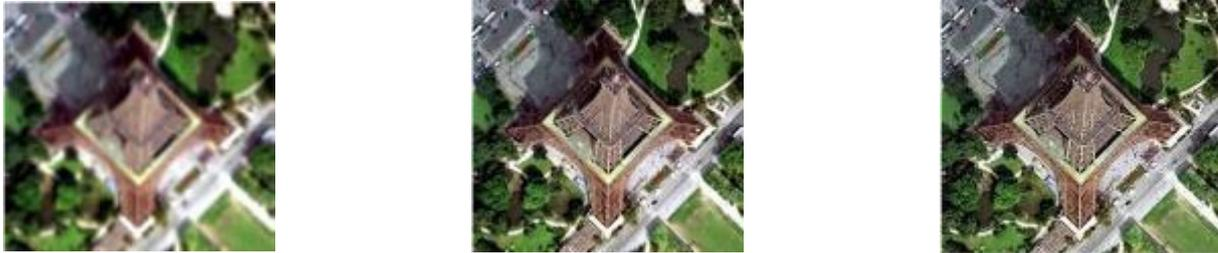
De gauche à droite, image satellitaire de la tour Eiffel en haute résolution (des détails de 250 cm sont visibles), très haute résolution (70 cm) et extrême haute résolution (30 cm). Crédit : CNES.
