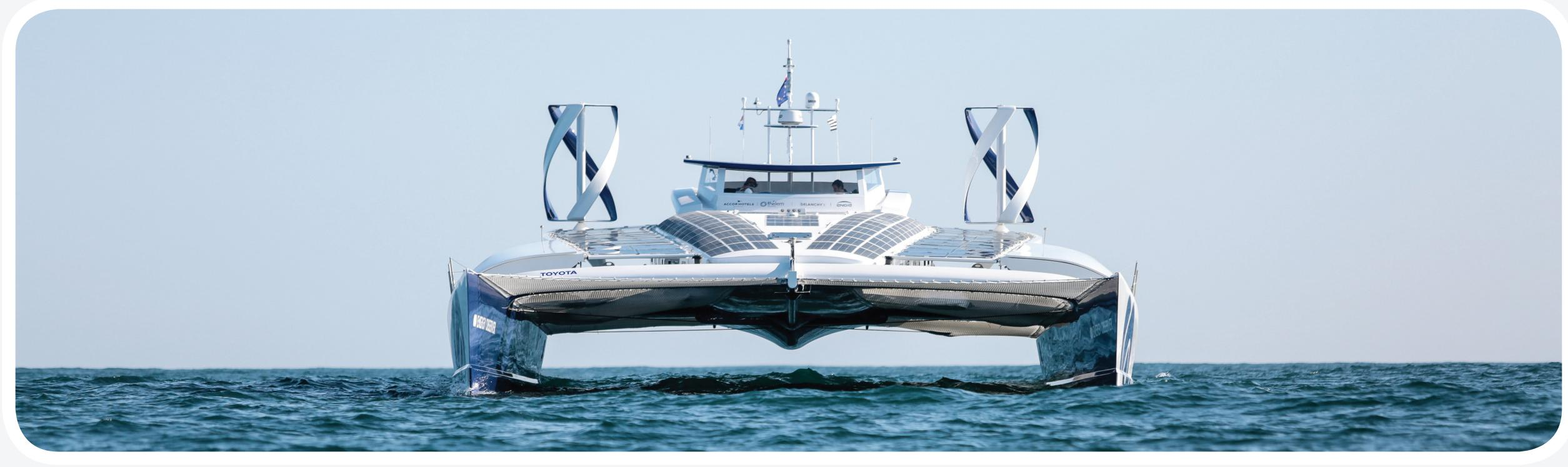
Développées avec l'ICAM de Nantes, elles ont été choisies pour l'absence de bruit, leur système antivibratoire et surtout la capacité à capter le flux quelle que soit sa direction. L'objectif était de miser sur la mixité énergétique et de bénéficier d'un appoint nocturne ou lorsque les conditions se dégradent.
