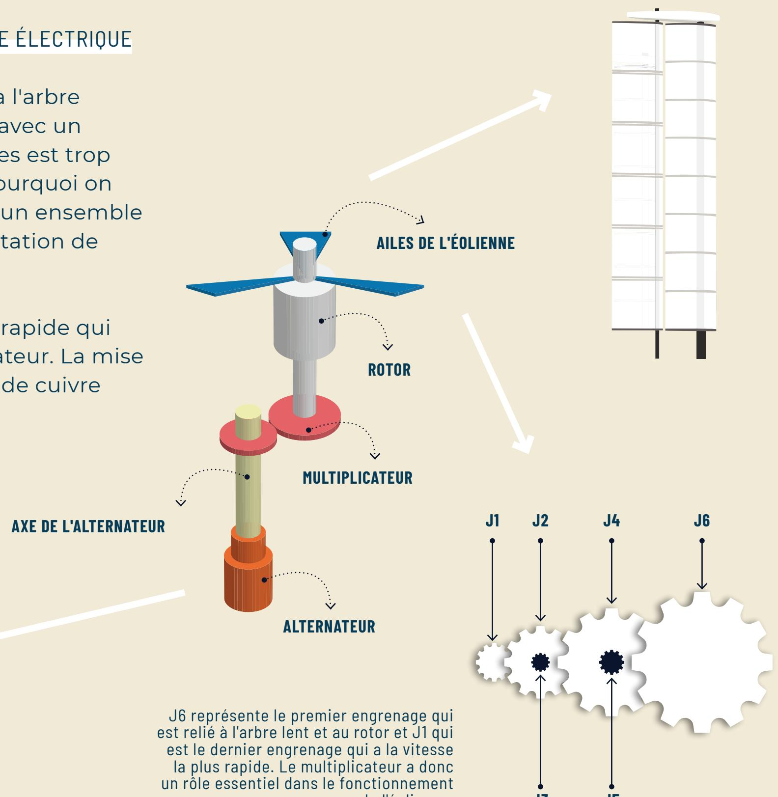
J6 représente le premier engrenage qui est relié à l'arbre lent et au rotor et J1 qui est le dernier engrenage qui a la vitesse la plus rapide. Le multiplicateur a donc un rôle essentiel dans le fonctionnement de l'éolienne.
