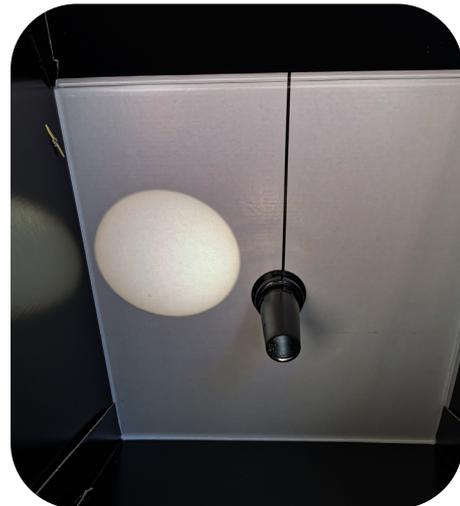
Le SolarScope est un exemple de dispositif qui permet de projeter, de manière tout à fait sûre, l'image du Soleil sur un support « écran » par l'intermédiaire d'une lunette de visée. Il est particulièrement bien adapté aux écoles, aux clubs et aux groupes.
